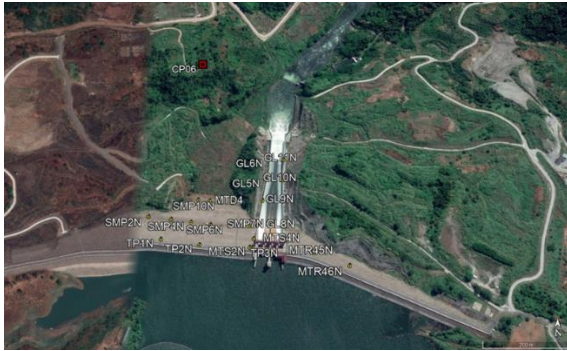
Gambar 1. Lokasi dan sebaran titik pantau deformasi Bendungan Jatigede
